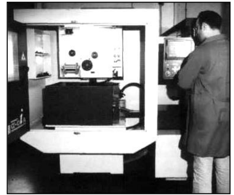
Рис. 8.3. Виготовлення матриць-філь'єр для екструзії ущільнювачів:
