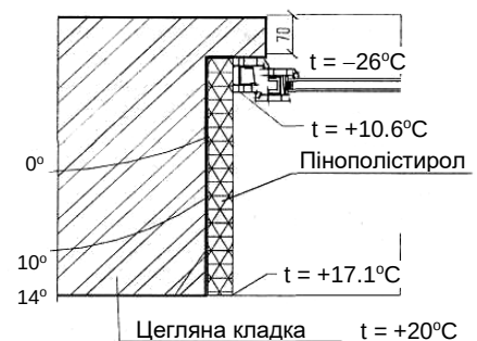
Рис. 6.9. Температурне поле у вузлі примикання вікна до стіни з одношарових керамзитобетонних панелей з віконним укосом, утепленим зсередини
