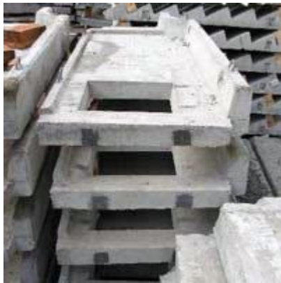
Плити з люком для влаштування зовнішніх евакуаційних сходів
