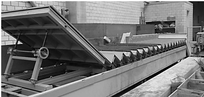
Рис. 2.12. Елементи системи регулювання розмірів сходинок
