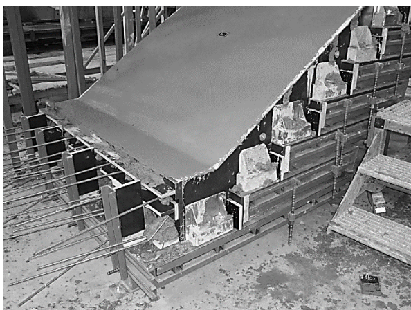
Рис. 2.28. Свіжозаформований виріб з анкерним пристроєм для петель
