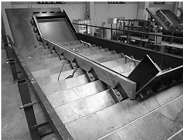
Рис. 2.15. Підготовка і армування стендових установок для виробництва сходових маршів в горизонтальному положенні
