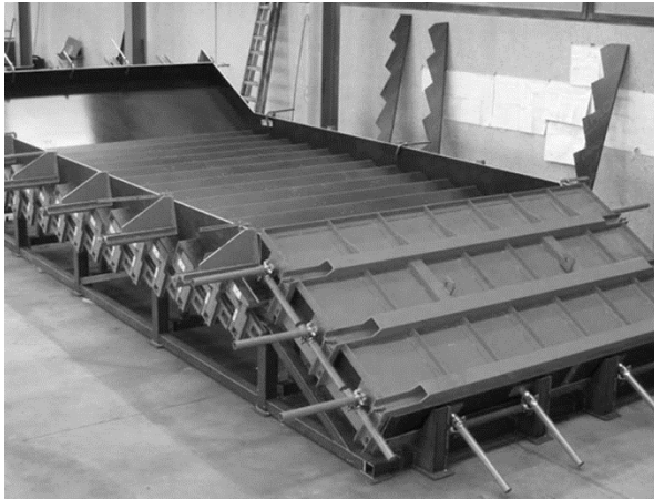
Рис. 2.8. Стендова форма для виготовлення сходових маршів в горизонтальному положенні з фіксованими розмірами
