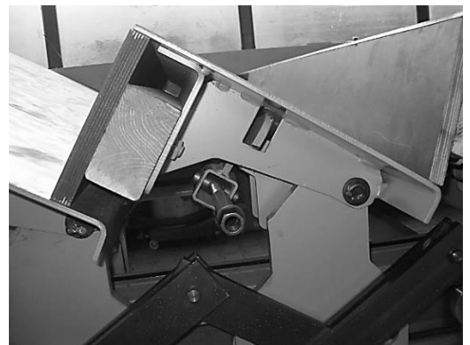
Рис. 2.12. Елементи системи регулювання розмірів сходинок
