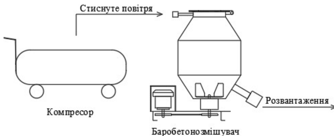
Рис.3. Принципова схема змішувача для приготування пінобетону за баротехнологією.
