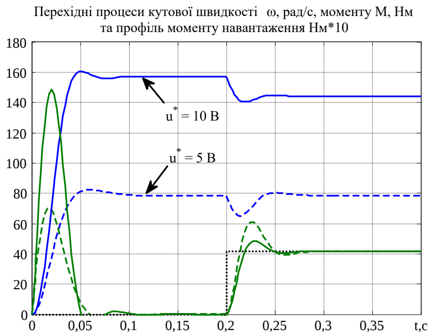
Рисунок 3.5 – Перехідні процеси по швидкості в замкненій системі при врахуванні обмеження вихідного сигналу регулятора
