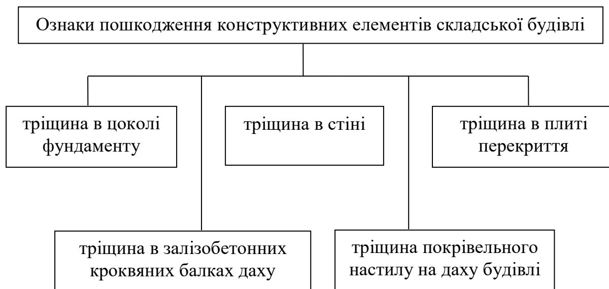
Рисунок 3.3 Схема ознак пошкодження конструктивних елементів будівлі
