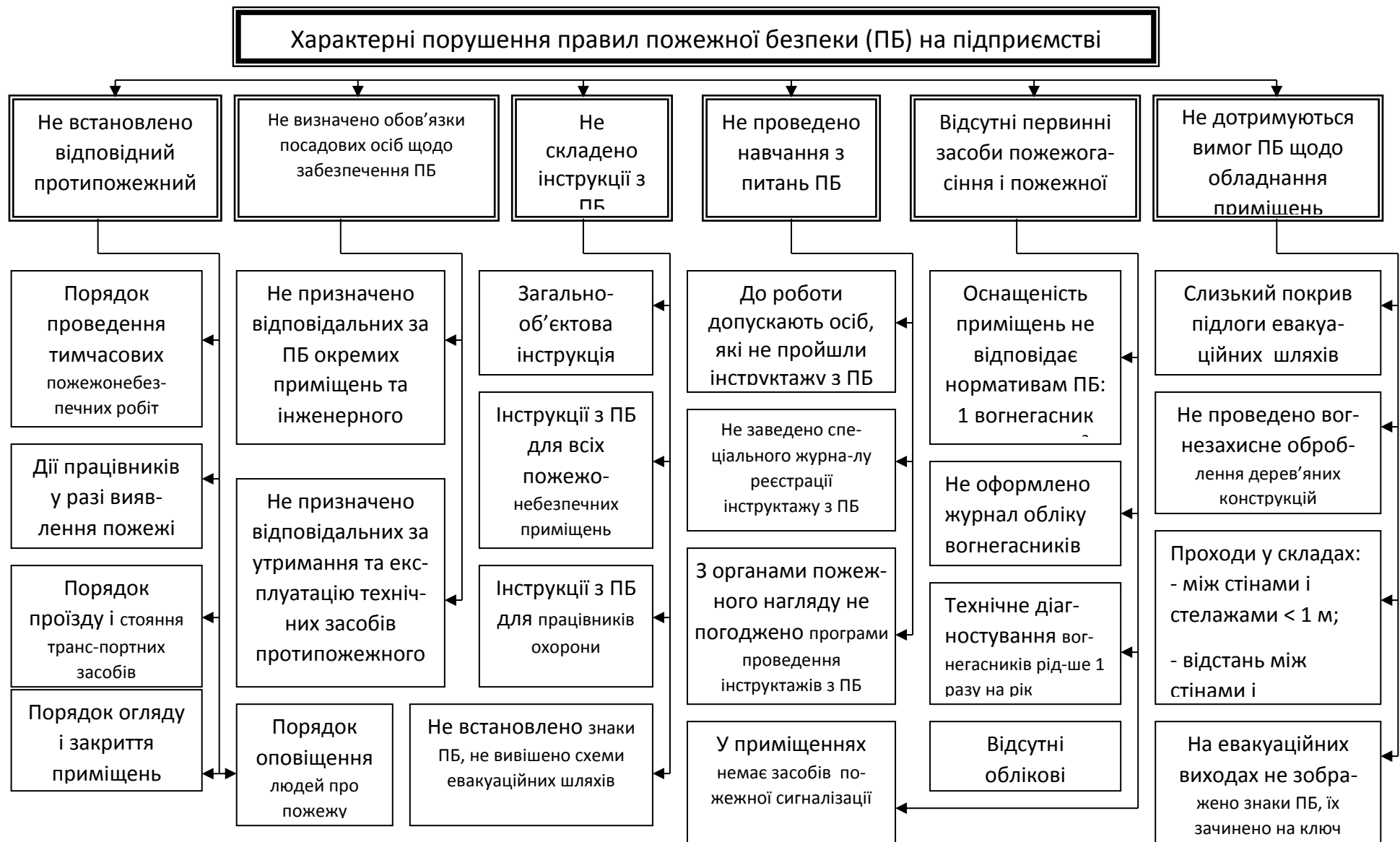
Рис. 3. Блок-схема основних порушень правил пожежної безпеки на підприємстві
