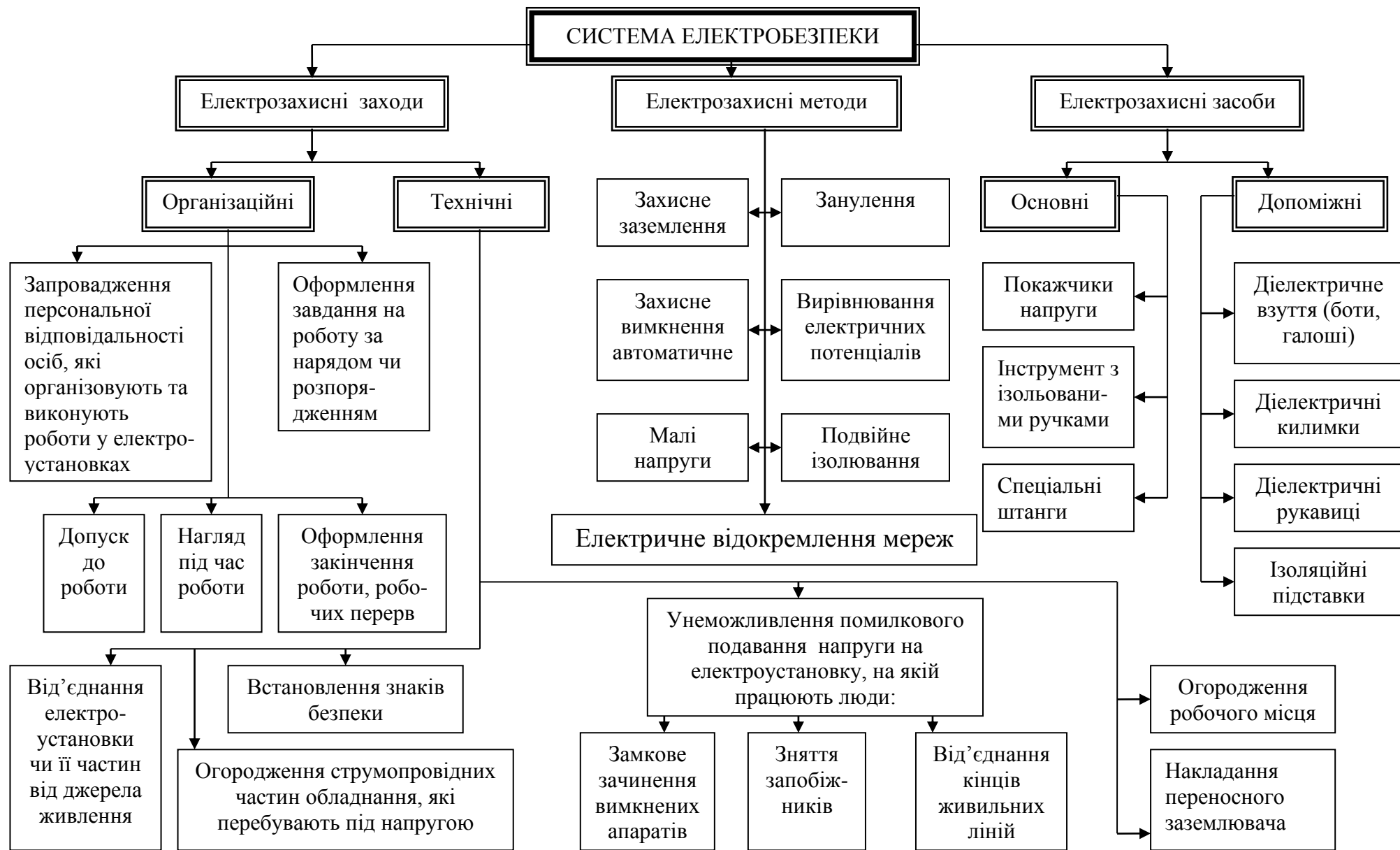
Рис. 2. Блок-схема системи електробезпеки
