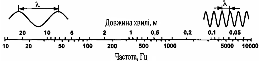
Рис.2. Залежність між частотою та довжиною звукової хвилі чутного діапазону.
