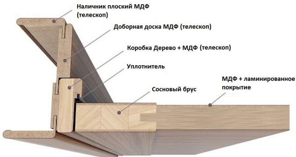
Варіант конструкції ламінованих дверей
