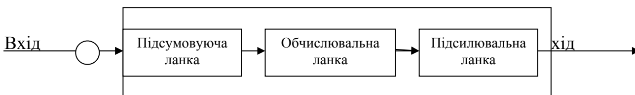
Рис. 6.1. Схема дій оператора як елемента у вигляді послідовного з'єднання трьох ланок
