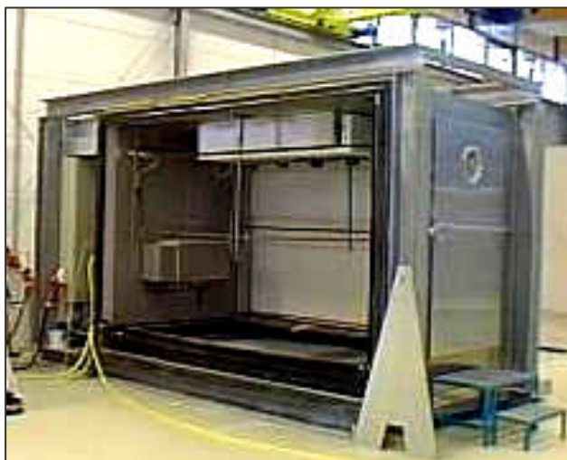
Рис.6.42. Спеціальна кліматична камера від Klima SYStems®
