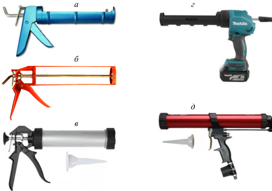
Рис.4.18. Типи монтажних пістолетів для використання герметиків: – механічні: а – напівкорпусний; б – скелетний; в – трубчастий; – електричний: з – акумуляторний; – пневматичний: д – на стиснутому повітрі
