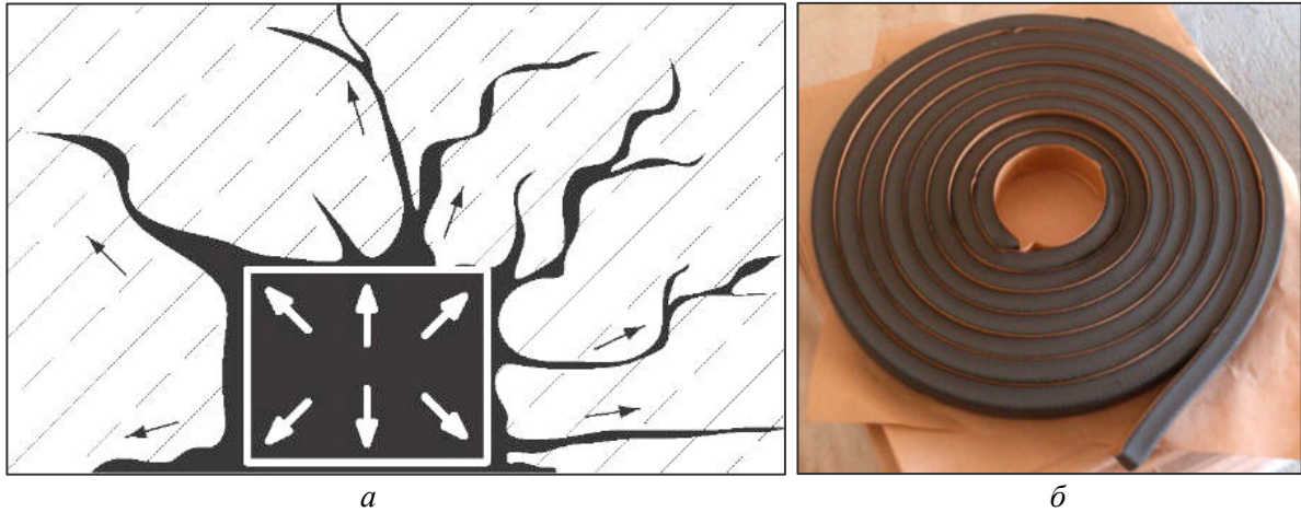
Рис.4.23. Бентонітовий гідроізоляційний джгут (шнур): а – схема роботи бентонітового шнура при набуханні в шві; б – зовнішній вигляд шнура
