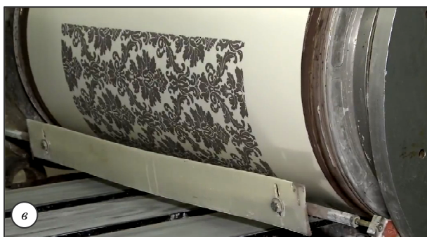
Рис.10.8. Декорування керамічної плитки: а – плоский трафаретний друк; б – ротатійний друк; в – ротатійний барабан з рисунком
