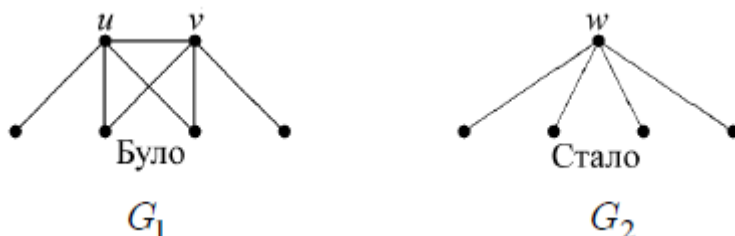
Рис. 3.168. Стягування графа G_1 до графа G_2
