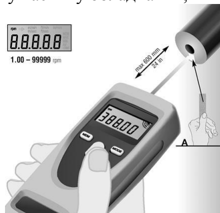
Рис.5.2 – Проведення заміру приладом testo 465
