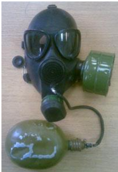
Рис. 5.2. Зразки сучасних протигазів, які використовують на теренах СНД: зліва-направо: ГП-5; ГП-7, ГП-7В
