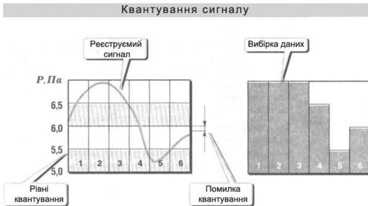
Рис. 9. Принцип квантування аналогового сигналу
