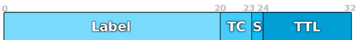
Рисунок 2.4 – Структура MPLS мітки
