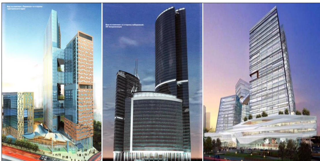
Рис. 2.10. Типи об'ємно-просторової композиції висотних будівель: a – окремий об'єм, що має яскраво виражену вертикальну спрямованість; б – декілька будівель баштового типу, що з'єднуються між собою; в – будівля в групі об'ємів різної поверховості
