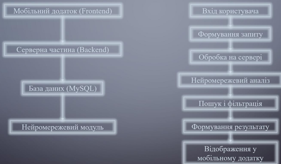
Схема загального алгоритму роботи програмного комплексу
