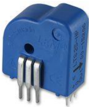
Рис. 6.8 – Зовнішній вигляд і основні характеристики датчика LTS-25NP (LEM)
