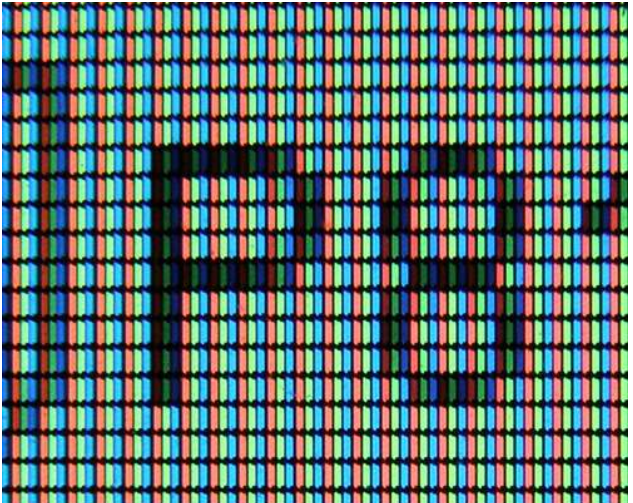
Рис. 1.3. Піксельна решітка на екрані LCD монітора
