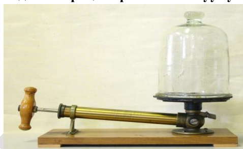
Скляна посудина з насосом для демонстрації отримання вакууму
