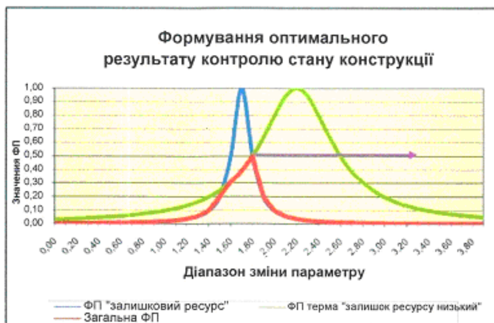
Рис. 1.17. Вигляд ФП для оцінки стану конструкції при нечіткому контролі
