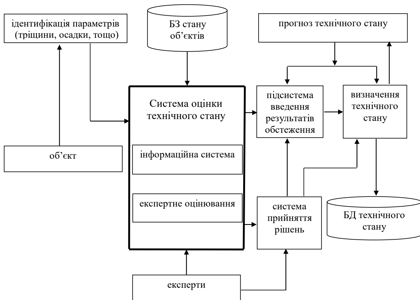
Рис. 1.23. Технологія проведення обстеження технічного стану будівель
