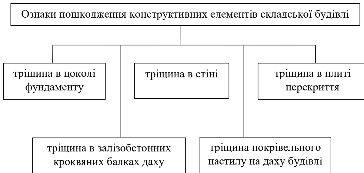
Рис. 2.5. Схема ознак пошкодження конструктивних елементів складської будівлі
