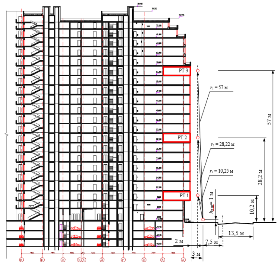
Рис. 1. Розташування джерела шуму та об'єктів шумозахисту на розрізі
