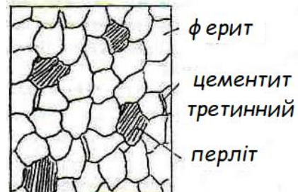
Рис.3.5. Мікроструктура залізовуглецевих сплавів з цементитом третинним (а) і схеми мікроструктури (б)
