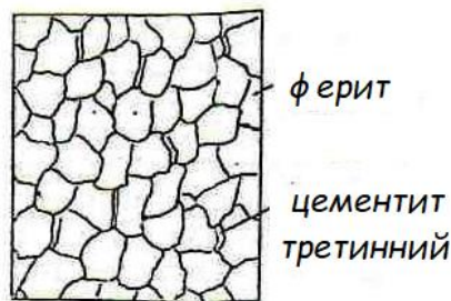
Рис.3.5. Мікроструктура залізовуглецевих сплавів з цементитом третинним (а) і схеми мікроструктури (б)
