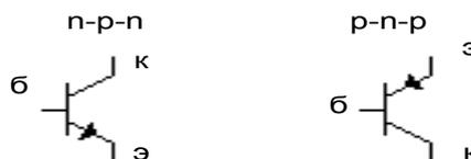
Рисунок 5.1 – Условное обозначение транзисторов
